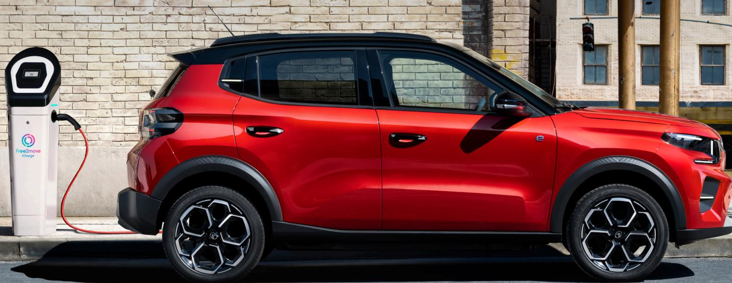
Rien de plus simple que de recharger son véhicule électrique chez soi : il suffit d'un **câble** et d'une **installation électrique**. Votre ë-C3 est livrée avec un **câble MODE 3**. En fonction de leurs caractéristiques, le temps de charge est plus ou moins rapide.
